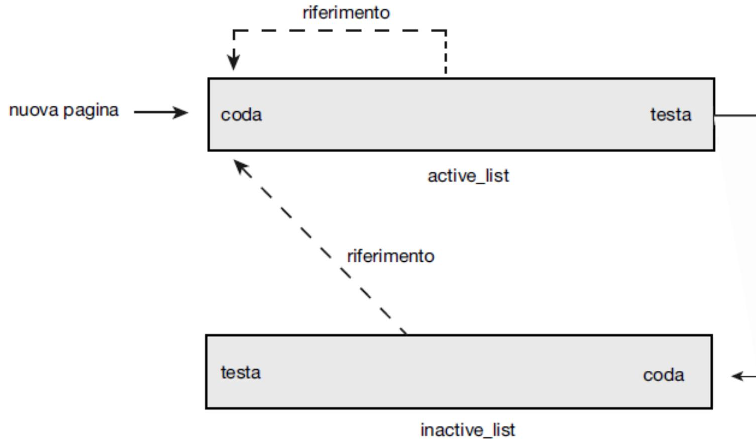
**Figura 10.29** Le strutture `active_list` e `inactive_list` di Linux.
