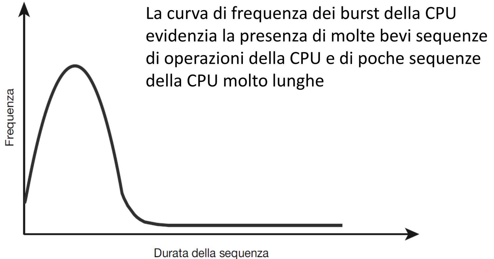
**Figura 5.2** Diagramma delle durate delle sequenze di operazioni della CPU.
