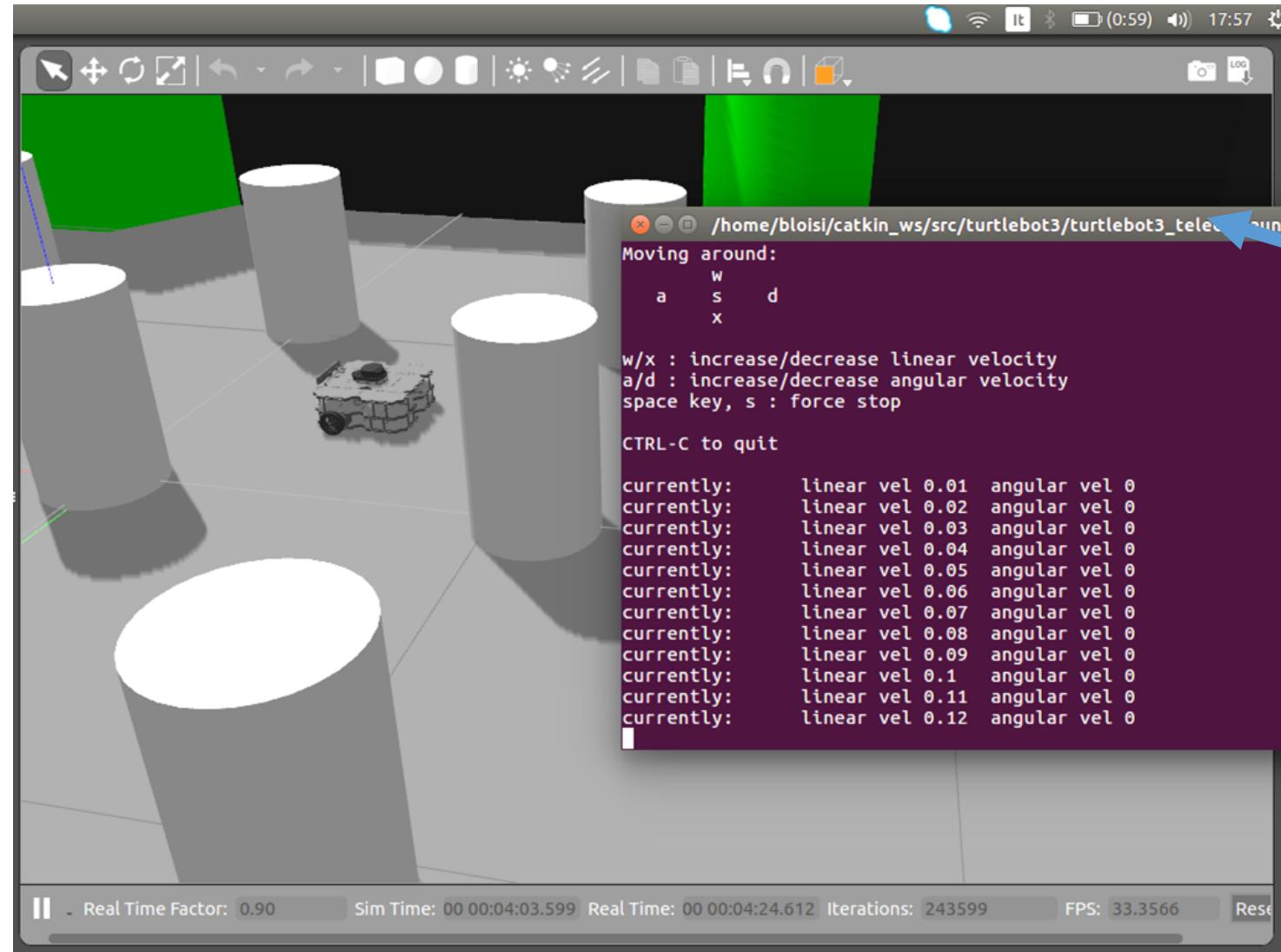
Per poter controllare il robot da tastiera, il terminal con il nodo teleop deve essere selezionato
