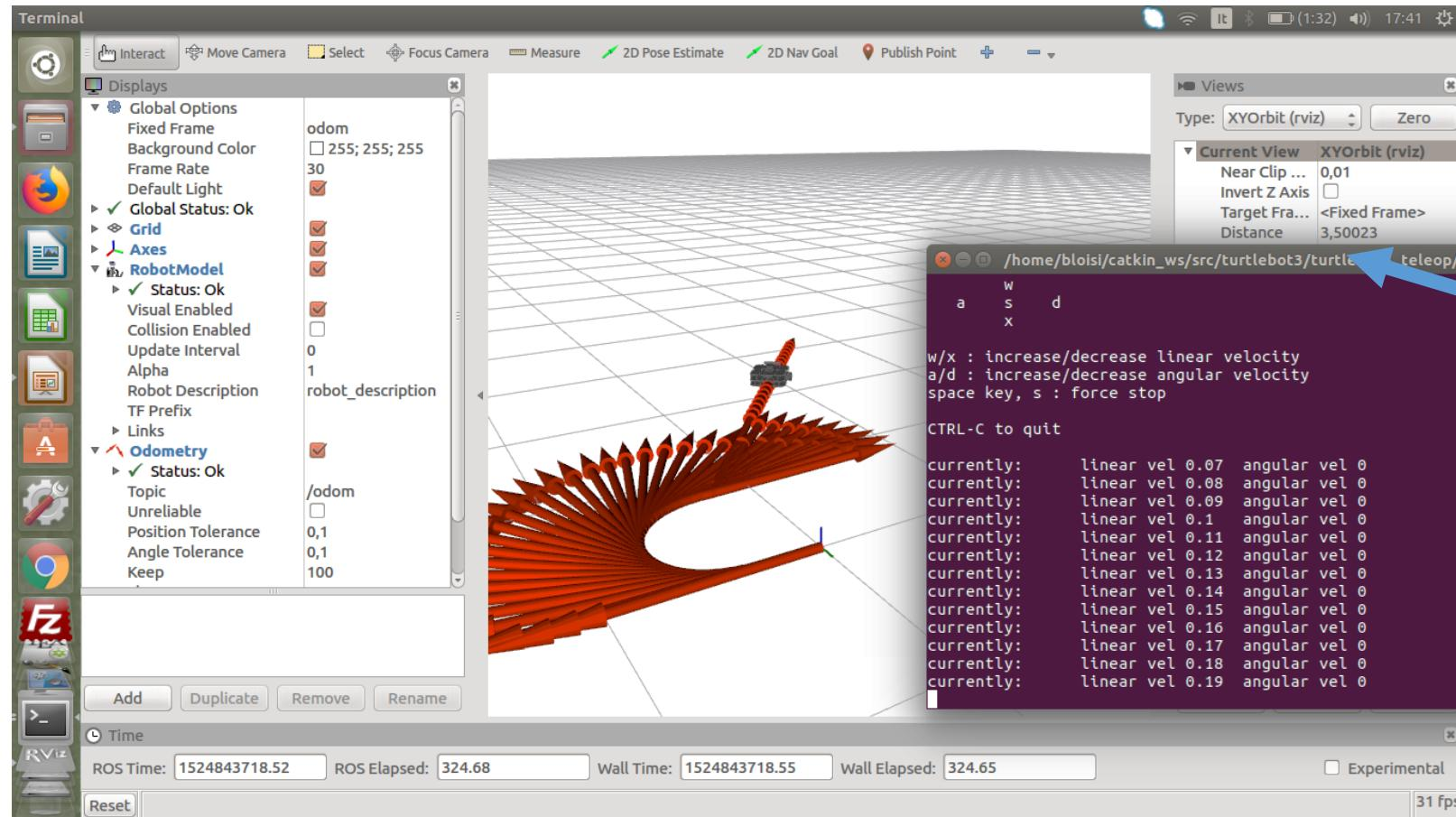
Per poter controllare il robot da tastiera, il terminal con il nodo teleop deve essere selezionato
